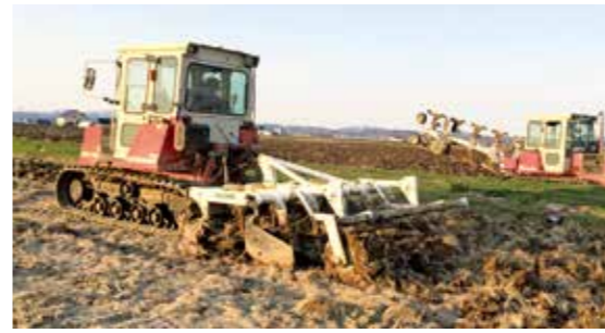
春耕起 手前スタブルカルチ、奥プラウ耕。直播安定収量の決め手⑤ 生育調査で得たデータを活用し、圃場ごとに施肥管理を行う⑥
