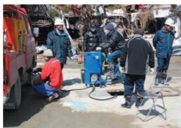
足踏み式ポンプで緊急車両へ給油
